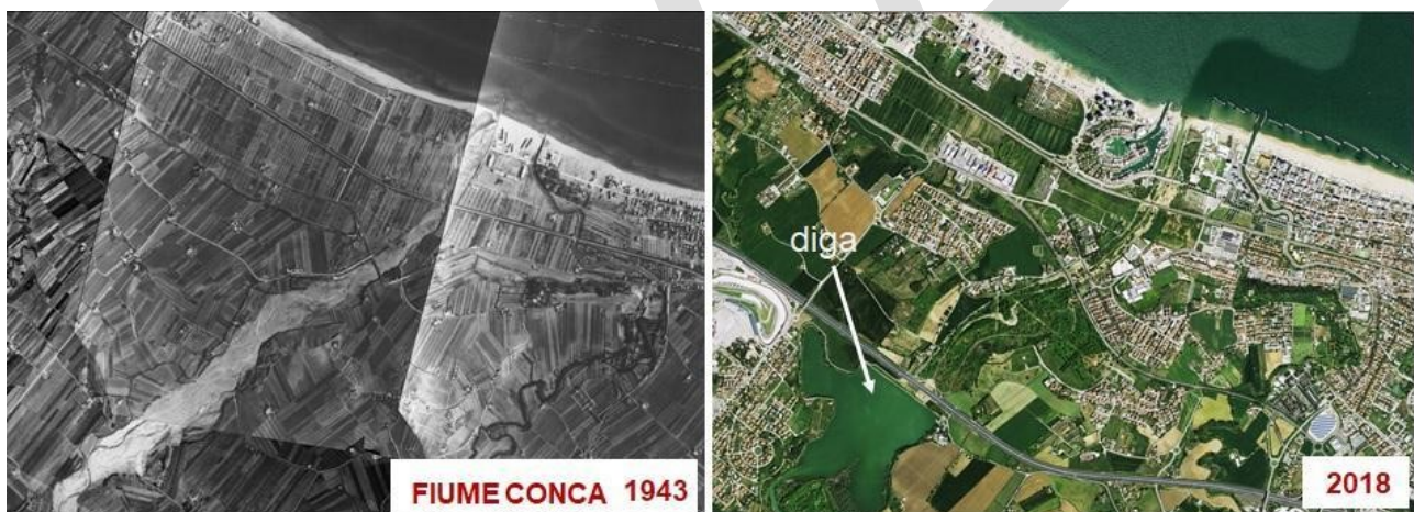
Figura A.2.3-8. La costruzione della diga sul fiume Conca, costruita a metà degli anni '70, e che ha definitivamente ostacolato l'apporto di sabbia e ghiaia alla costa. Le due immagini mostrano come è cambiato il corso d'acqua dagli anni '40-'50 ad oggi
